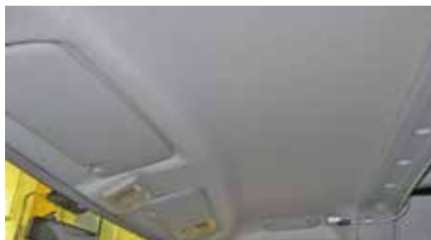
Leichte Farbveränderungen durch Sonneneinstrahlung Innenwandverkleidung hinter dem Fahrersitz gerissen
