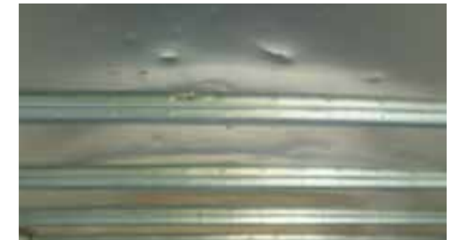
Dachfläche: Leichte Verformung entsprechend dem Erscheinungsbild des Fahrzeugs
