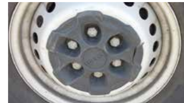
Radabdeckungen: Verformt, gebrochen, Material fehlt oder entfernt
