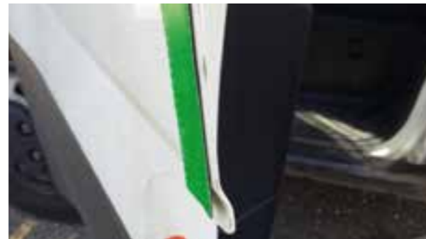
Lackschaden an Türkante
