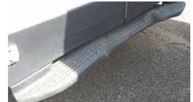
Hintere Trittbretter: Verformungen, die nicht auf wirtschaftliche Weise repariert werden können
