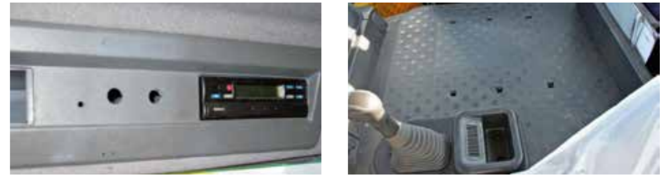
Bedienelemente-, Sitz- oder Verkleidungsteile fehlen, sind gebrochen oder durchbohrt Systeme, Sicherheitsgurte, Sitzverstellung, Displays und Anzeigen funktionieren nicht
