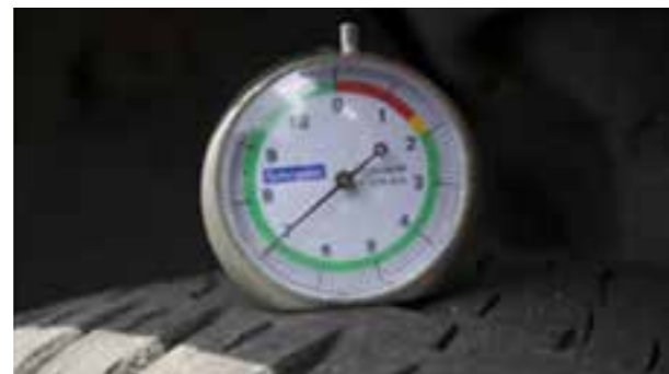
Reifen: Profiltiefe \geq 5 mm (ERFÜLLT) Anmerkung: Der Reifenverschleiß wird in der am meisten abgenutzten Profilirille am Reifen gemessen.
