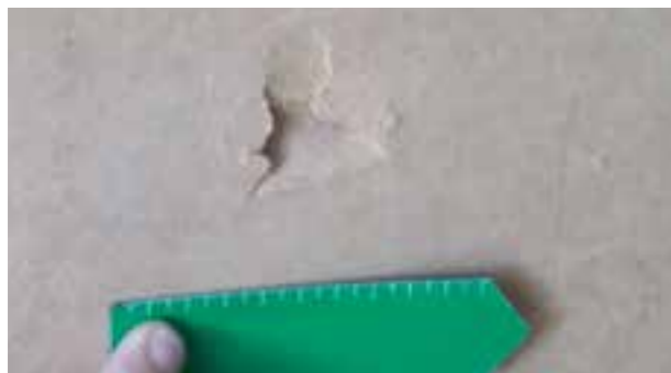
Innenraumverkleidung : Kleine Stoßspuren
