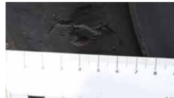
Reifen: Beschädigungen > 3 mm, abgetragen
