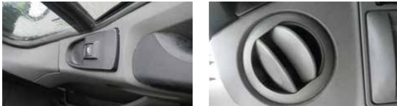
Leichte Farbveränderungen durch Sonneneinstrahlung Leichte Verschmutzungen können durch eine fachmännisch durchgeführte chemische Reinigung entfernt werden
