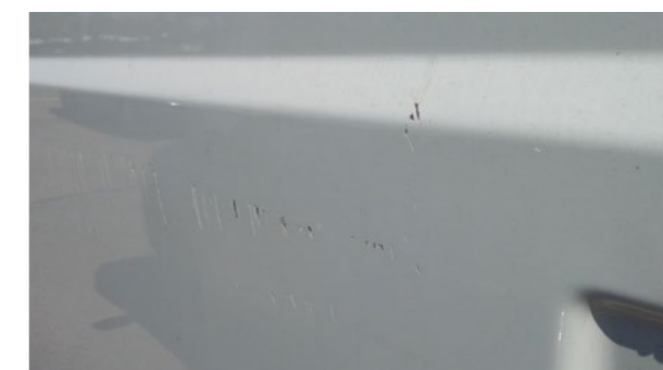
Kratzer > 20 mm Bitte beachten: Bei den hinteren Schwenktüren ist es nicht möglich, nur eine zu lackieren
