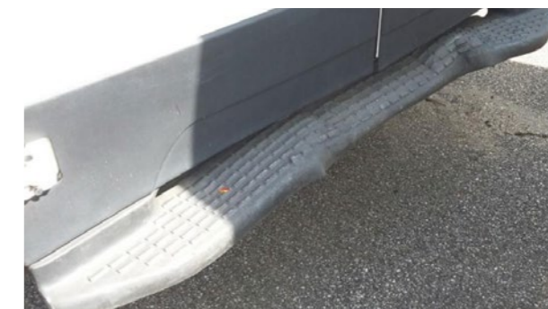
Hintere Trittbretter: Verformungen, die nicht auf wirtschaftliche Weise repariert werden können
