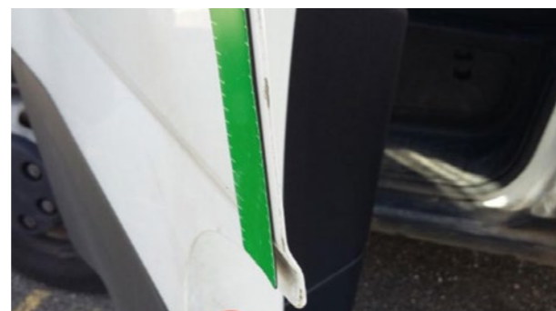
Lackschaden an Türkante
