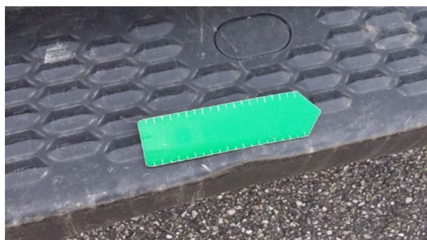
Hintere Trittbretter: Leichte Verformung
