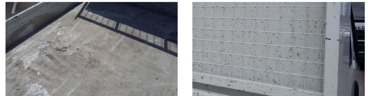
Spuren von Beton oder chemischen Produkten, die  $\geq$  1/4 der Oberfläche des Trichters bedecken
