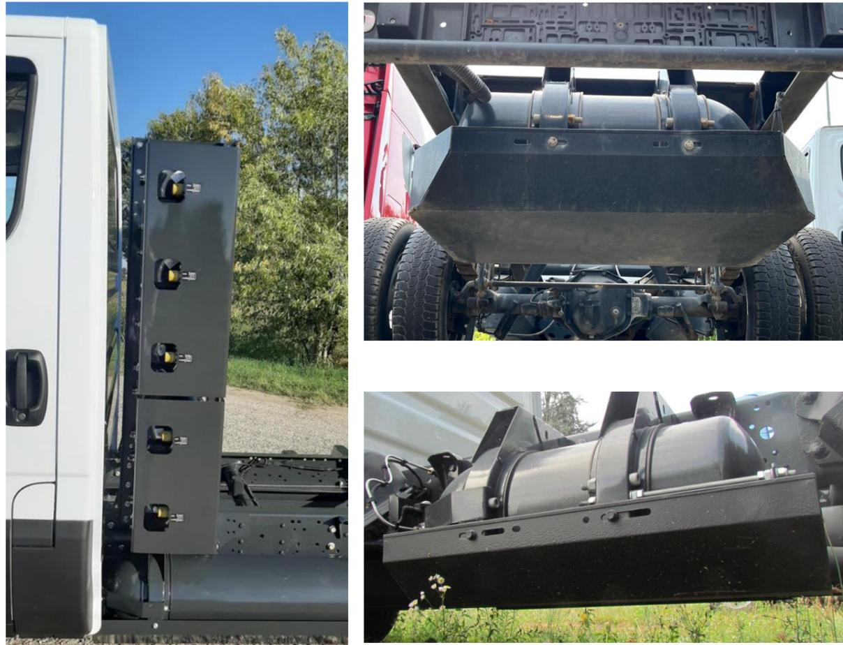
Schutzabdeckungen für CNG-Zylinder müssen in ordnungsgemäßem Zustand zurückgegeben werden, wie in den Bildern dargestellt.
