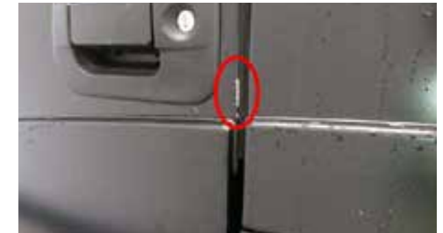
Éclat sur tranche de portes
