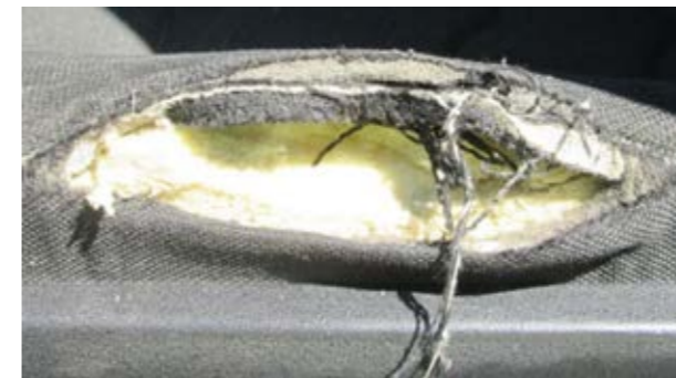
Manque de mousse, ou structure cassée
