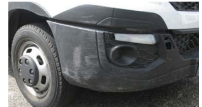
☒ Arrachement de matière ou déformation dans la limite économique ou de faisabilité
