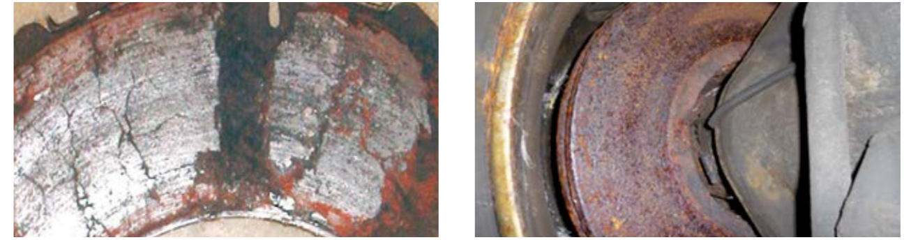
Disques de frein rouillés, rodés, usés
