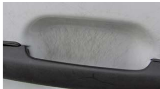
☑ Légères rayures superficielles, par ex. au niveau du bouchon de réservoir, des trappes, poignées de portes, des pare-chocs et des moulures
